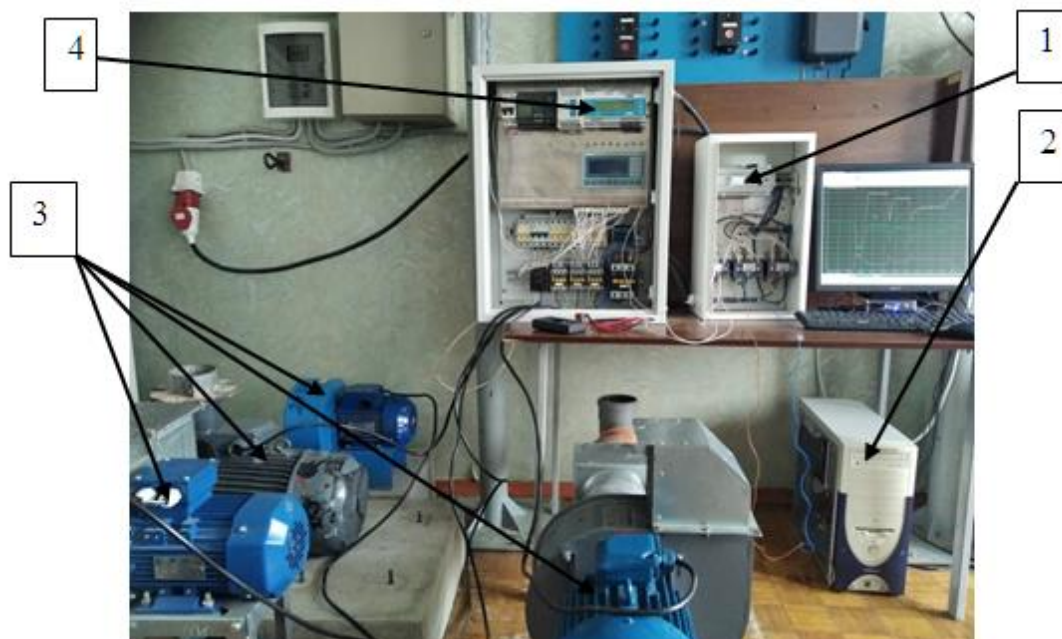
Рисунок 3.2 – Общий вид экспериментального стенда для исследования влияния очередности запуска электродвигателей на выходные показатели системы: 1 – регистратор РПМ-16-4-3 ; 2 – компьютер; 3 – электродвигатели; 4 – программируемый логический контроллер
